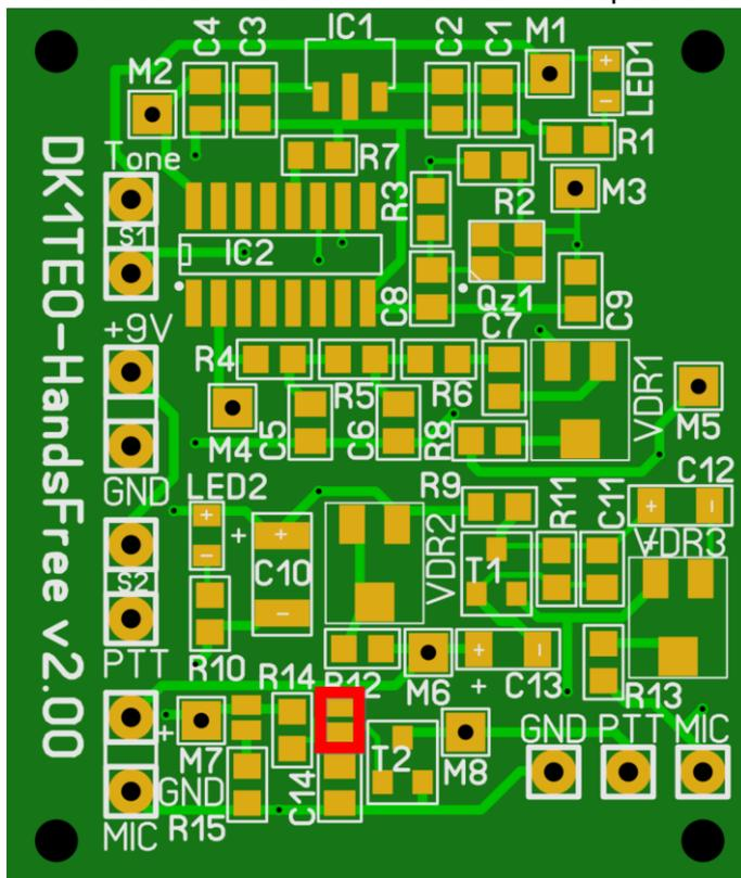
Die Lötbrücke zwischen M7 und R14 ist optional und aktiviert einen Widerstand, der verhindern soll, dass wenn HF vom Funkgerät ins Gehäuse einkoppelt und dauerhaft PTT betätigt wird.
