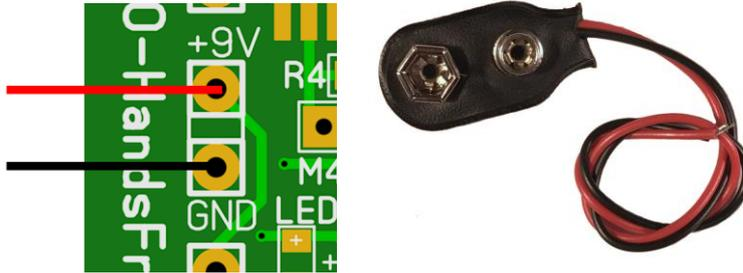
**HINWEIS:** Für die Schaltung wird eine externe Spannungsquelle empfohlen, da die meisten internen MIC-Stromversorgungen der Funkgeräte für die Schaltung zu schwach sind! Ein Stecker ist beiliegend.
