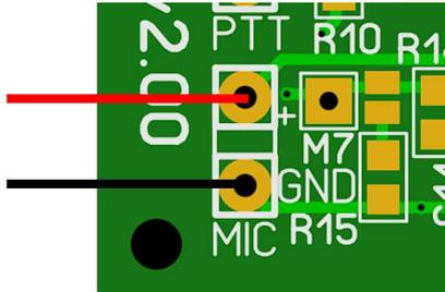
Bei Verwendung des mit Klinkenstecker ausgestatteten Mikrofons, sollte mithilfe eines Durchgangsprüfers/Ohmmeters bei eingestecktem Mikrofon ermittelt werden, welcher der Plus-Pin (am Stecker) des Mikrofons ist. Der lange PIN des Steckers ist in der Regel GND. Das Mikrofon, sowie Stecker werden nicht mitgeliefert.
